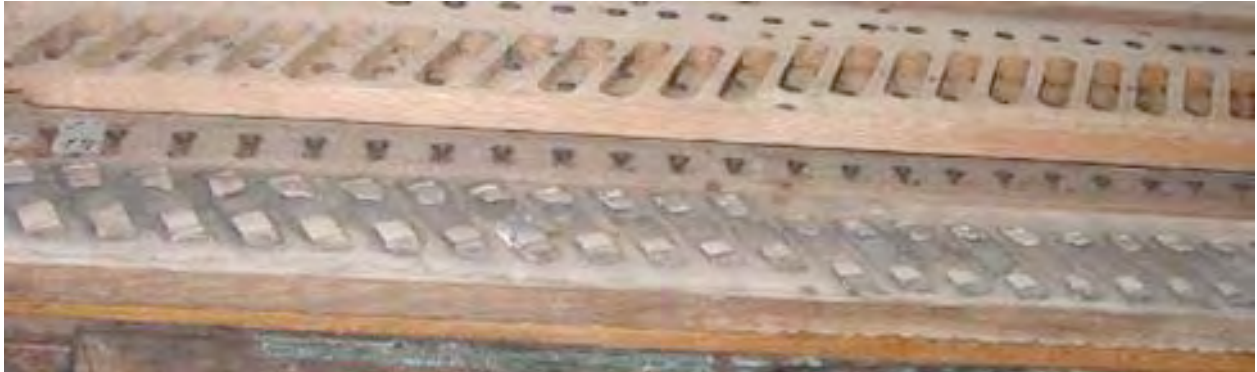
Repräsentativer Transmissionsstock (Nr. 6): unten: die untere Hälfte des Stockes mit den Rückschlagventilen aus Leder; oben: die umgedrehte obere Hälfte des Stockes mit den Transmissionskammern [zwischen den Stockhälften ist Stock Nr. 5 sichtbar] (Foto: Martin Schulze)
