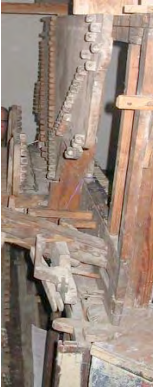
Wellenbrettanlage: Oben rechts: Hauptwellenbrett (f. 2. Manual und teilweise f. 1. Manual) Oben links: kleines Wellenbrett (für Wellen des 1. Manuals), lagernd auf dem Rahmen des 2. Manuals Unten links im Bild ist das Wellenbrett (nicht in Position) für die Stecher des 1. Manuals erkennbar (Foto: Martin Schulze)
