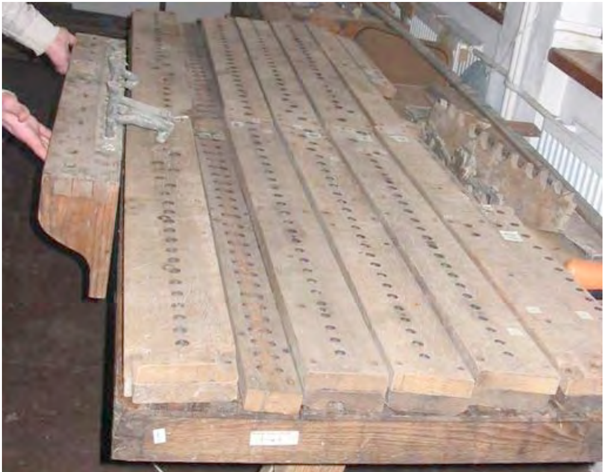
Windlade (mit nur locker aufgelegten Stöcken): von links nach rechts: Stock Nr. 6 mit angesetzter Pfeifenbank für die Abkonduktion von 12 Basspfeifen / Stock Nr. 5 (verändert) für ursprünglich 2 Register / Stock Nr. 4 bis Nr. 2 / Stock Nr. 1 (Diskant) mit direkt angesetzten Prospektstöcken (Foto: Martin Schulze)
