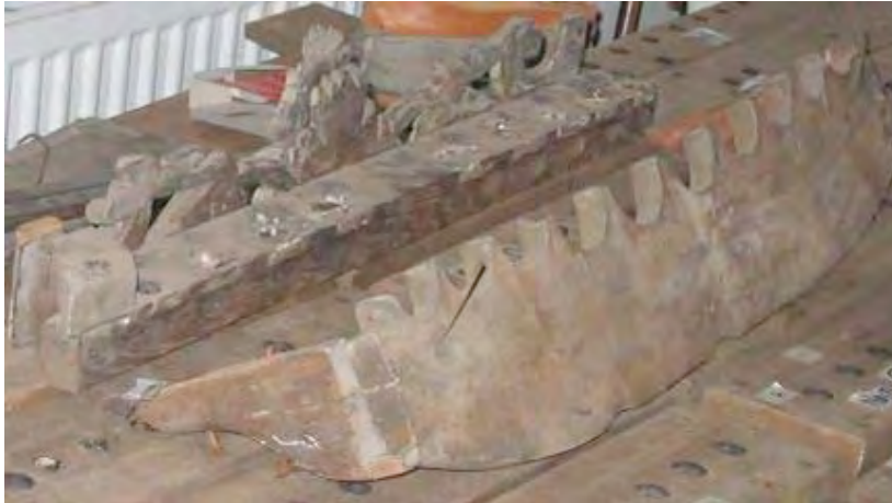
Prospektstock und Pfeifenraster des Mittelfeldes (Foto: Martin Schulze)
